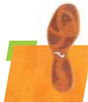
Phylon premoldeado de 45 Shore A de dureza junto a caucho de abrasión 95N/mm<sup>3</sup>, densidad de 1.21g/cm<sup>3</sup> y que supera 200.000 ciclos de flexión, son resultados de la suela ideal para deportes de indoor. Caucho seccionado más ligero en la zona de apoyo. Cosida al corte y doble pegado en la base, son garantía total.
